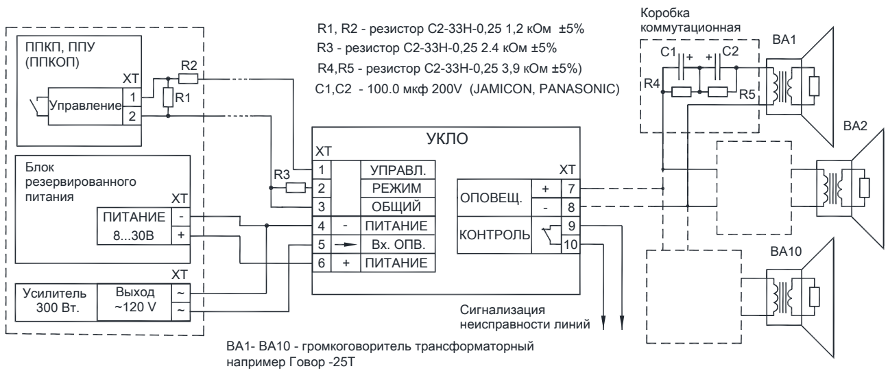
Рис. 3. Схема подключения УКЛО для контроля линии речевого оповещения.
